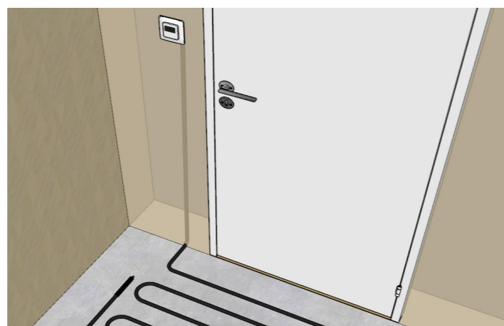
Utlegging av TF SVK2 varmekabel
