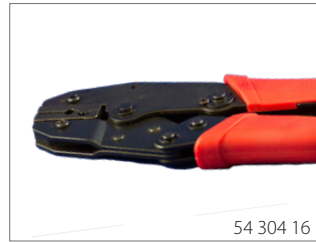
TFV MOMENTPRESSTANG Brukes ved festing av tilkoblingsklemmer på TF varmemefolie.
